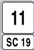
FIG. 268 art. 129 PROGRESSIVA DISTANZIOMETRICA PER STRADA COMUNALE
