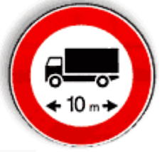
FIG. 67 art.118 TRANSITO VIETATO AI VEICOLI, O COMPLESSI DI VEICOLI, AVENTI LUNGHEZZA SUPERIORE A ... METRI
