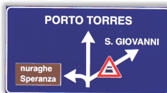
FIG. 240 ART. 127 SEGNALE DI PREAVVISO DI INTERSEZIONE EXTRAURBANA CON PASSAGGIO A LIVELLO SU UN RAMO DELLA INTERSEZIONE
