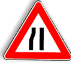
FIG.18 art.90 STRETTOIA ASIMMETRICA A SINISTRA
