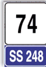
FIG. 266 art. 129 PROGRESSIVA DISTANZIOMETRICA PER STRADA STATALE
