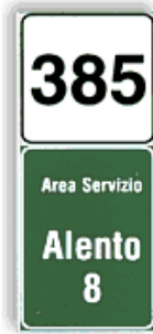
FIG. 264 art. 129 PROGRESSIVA DISTANZIOMETRICA AUTOSTRADALE
