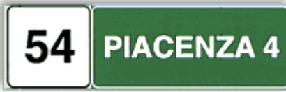
FIG. 263 art. 129 PROGRESSIVA DISTANZIOMETRICA AUTOSTRADALE
